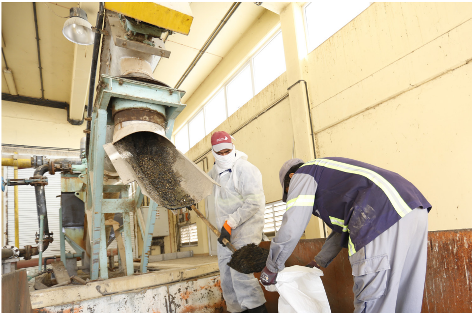
Operarios de la planta seleccionando y separando en sacos los lodos deshidratados
